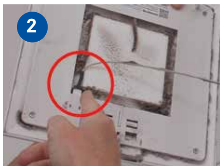
Kabel vom Feuchtigkeitssensor vorsichtig entfernen
